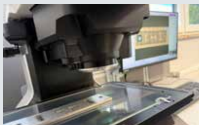
Multisensor Messmaschine zur Bauteil Vermessung
