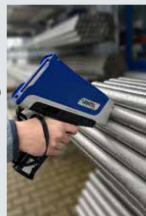
RFA-Handanalysator zur sofortigen Identifikation von Materialien und ihrer chemischen Zusammensetzung.
