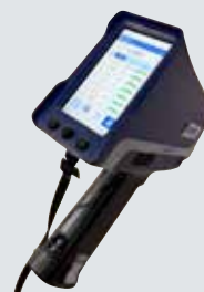
RFA-Handanalysator zur sofortigen Identifikation von Materialien und ihrer chemischen Zusammensetzung.
