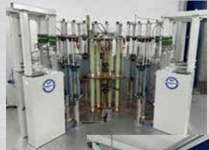
Prüflabor mit Stoßstromanlage 200kA (10/350 \mu s)
